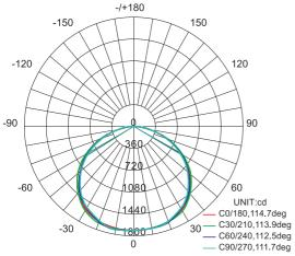
Durchschnittlicher Strahlungswinkel (10%)\_ 112.36 DEG
